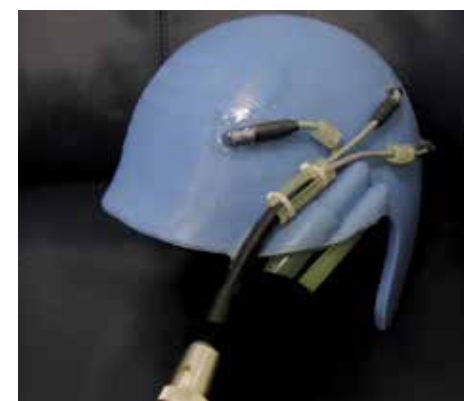
Silikonkappe mit weicherer innerer Oberfläche über die eine Neoprenkappe gezogen wird.
